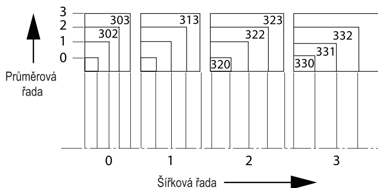
Obr. 6-6 Originální systém označování kuželíkových ložisek
